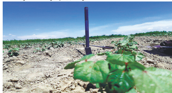
Рис.1. Процесс измерения почв с помощью прибора UMP-1 Environmental-Device-Technology (Umwelt-Geräte-Technik GmbH)
