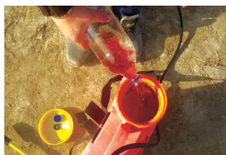
Рис.3. Процесс подготовки раствора с препаратом Биосольвент и внесения в почву перед промывкой
