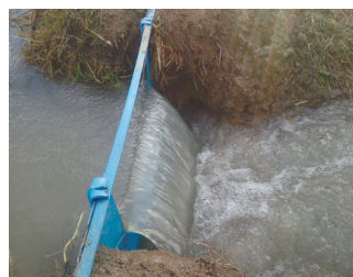
Рис.5. Учет подаваемой воды на промывку с помощью водомера "Чиполетти-75"
