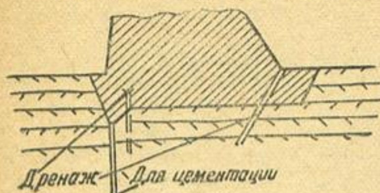
Рис. 34. Дренаж основания плотины при горизонтальном напластовании скалы
