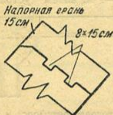
Рис. 54. Рабочий шов напорной плиты плотны Кингздом
