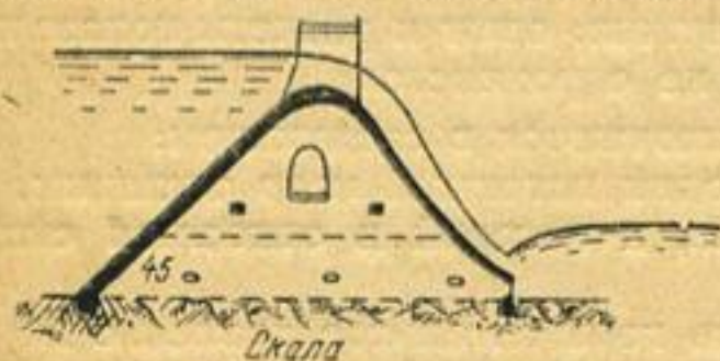
Рис. 92. Полый железобетонный водослив на скале (профиль)
