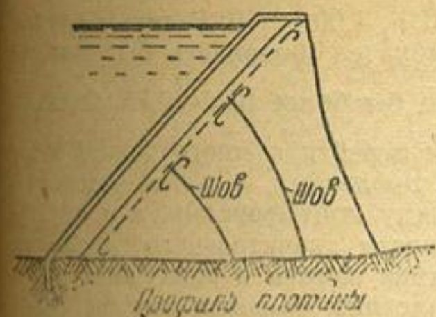
Рис. 57. Профиль плотины Биг Долтон. H=55 м. Часть арматуры проходит через шов. Заметных трещин нет
