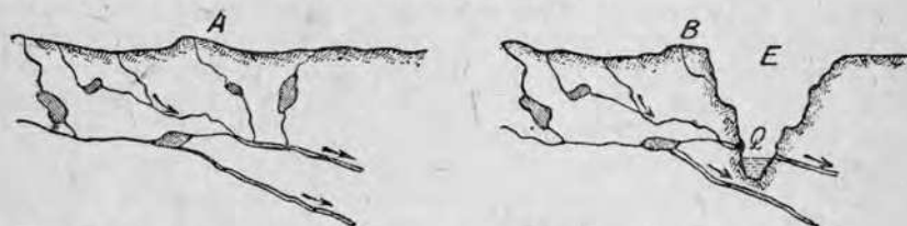
Рис. 7. Схематическое изображение источника, питаемого подземным водотоком.
