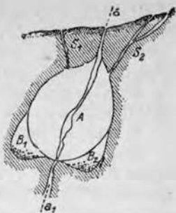
Рис. 147. Схематическое изображение образовавшейся вследствие коррозии и эрозии подземной пустоты.
