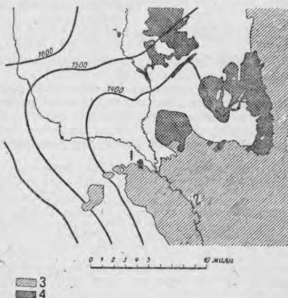
Рис. 89. План в гидроизогипсах грунтовой воды в артезианском бассейне Южной Дакоты (по Тодду и Голлу). 1 — Митчелль; 2 — Джеймс-Ривер; 3 — район с зеркалом грунтовых вод, лежащим под поверхностью земли; 4 — район с самоизливающимися артезианскими водами.
