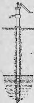
Рис. 208. Абиссинский или нортоновский колодец.
