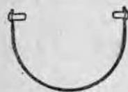
Рис. 56. Снабженный особой пружиной для открывания запор для наблюдательных труб.
