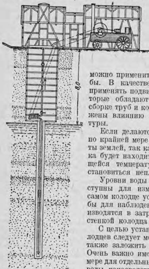
Рис. 194. Опытный колодец с шахтой при глубоко лежащем зеркале грунтовых вод.
