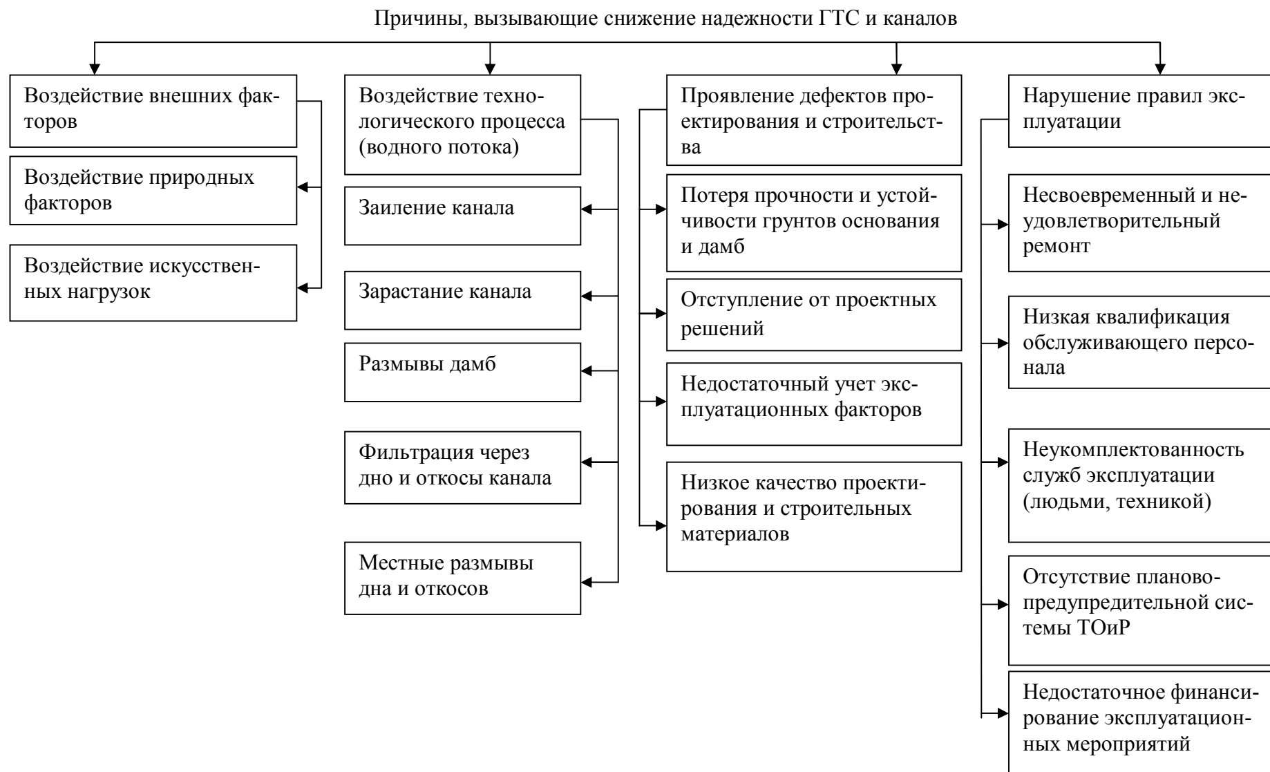
Рисунок 8 – Причины, вызывающие снижение надежности ГТС и каналов
