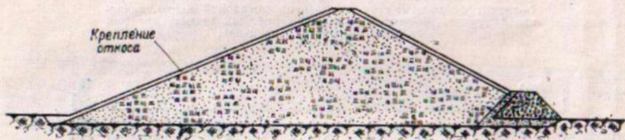
Рис. 6. Земляная плотина из опородного грунта.
