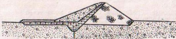
Рис. 16. Плотина смешанного типа с понуром и экраном.
