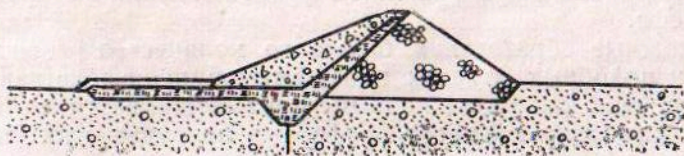
Рис. 16. Плотина смешанного типа с понуром и экраном.
