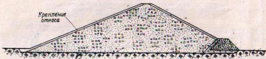
Рис. 6. Земляная плотина из однородного грунта.
