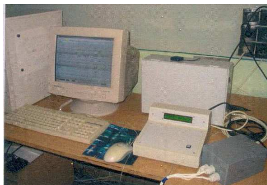
Рис. 2. Сейсмическая станция CPC-KM/V-F.
