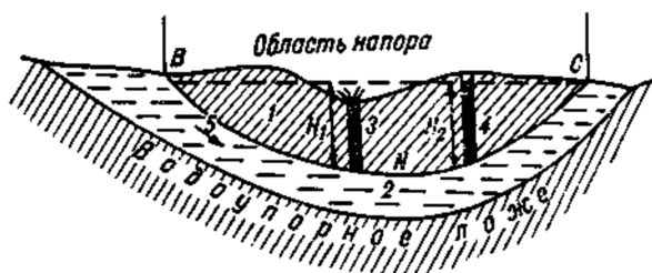
Схема строения артезианского бассейна.
