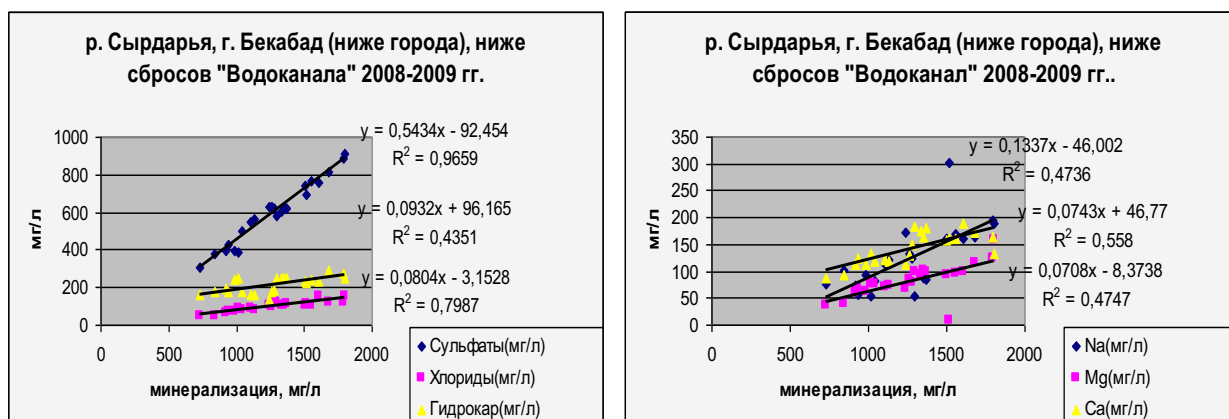
Рис. 3. Математические зависимости содержания главных ионов от величины минерализации речной воды: р. Сырдарья – г. Наманган (кишл. Каль), р. Сырдарья – г. Бекабад – ниже города
