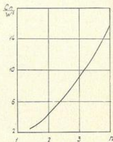
Рис. 21. График функции показателя действия взрыва при взрывании в глинах
