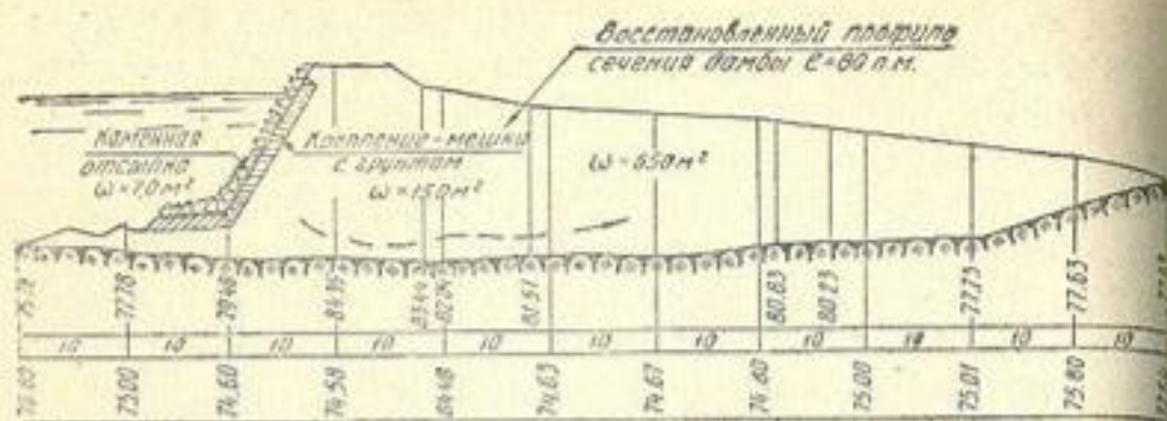
Рис. 12. Схема заделки прорыва на ПК 175+50 на канале им С. М. Кирова.
