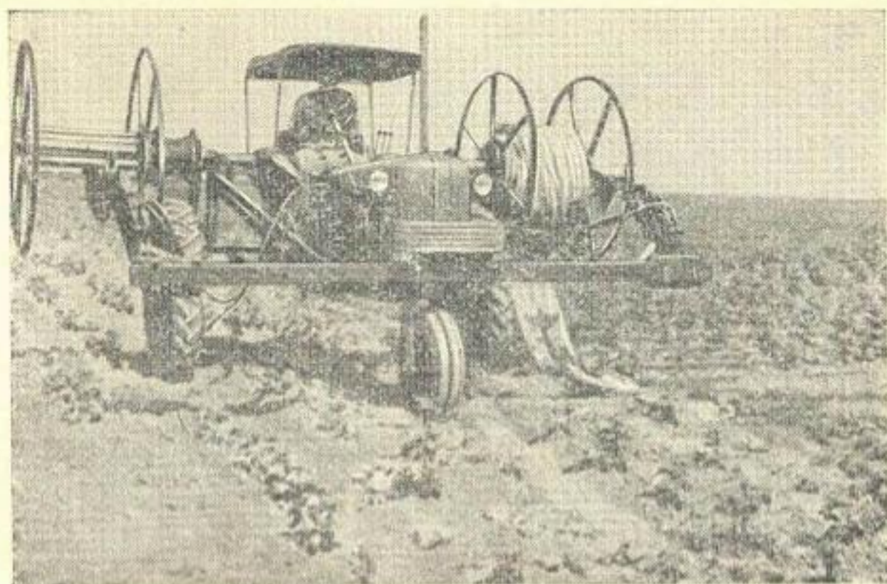
Рис. 46. Прямая сборка гибкого трубопровода после полива при движении трактора задним ходом.
