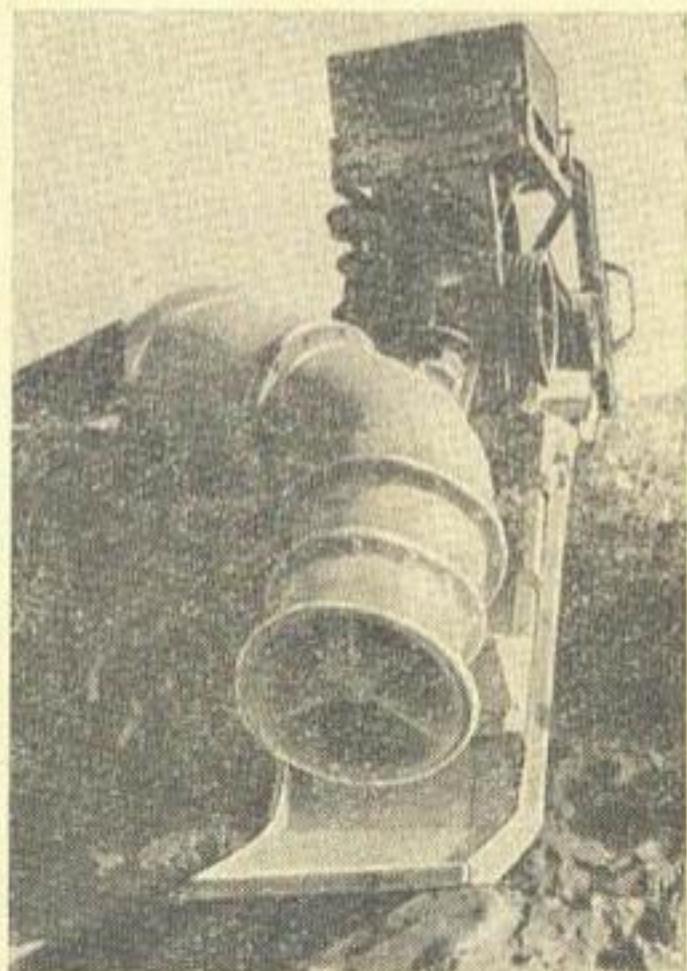
Рис. 50. Передвижная насосная станция ПВУ-200 с пропеллерным насосом из алюминиевого сплава, обеспечивающая расход 120—200 л/с при напорах 2,4—1,5 м.
