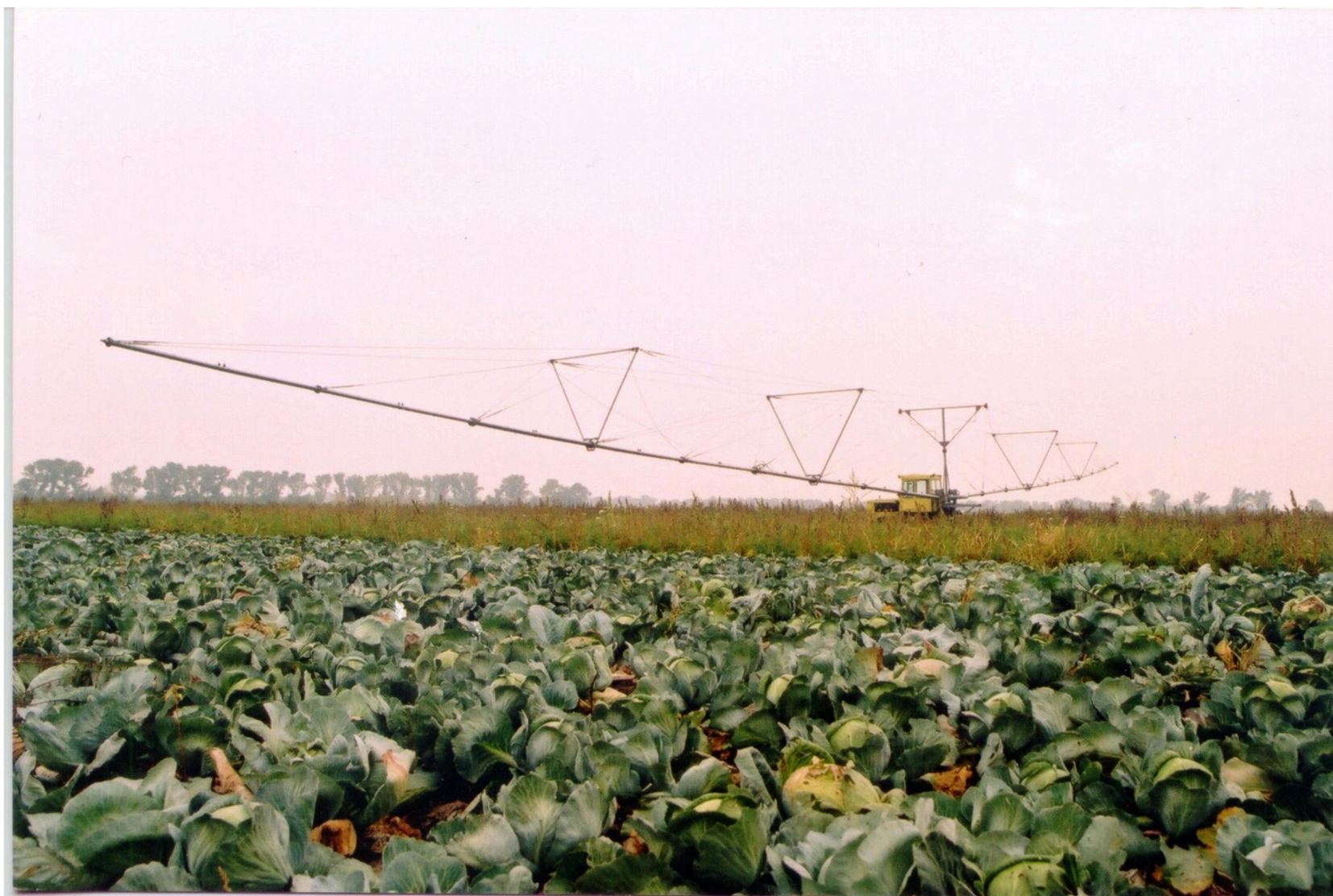
Рис. 4. Дождевальная машина ДКФ-1П
