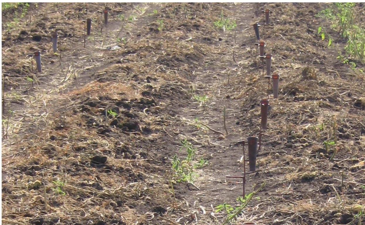
Рис. 10 Схема расстановки дождемерных бачков при поливе ДКФ-1ПК
