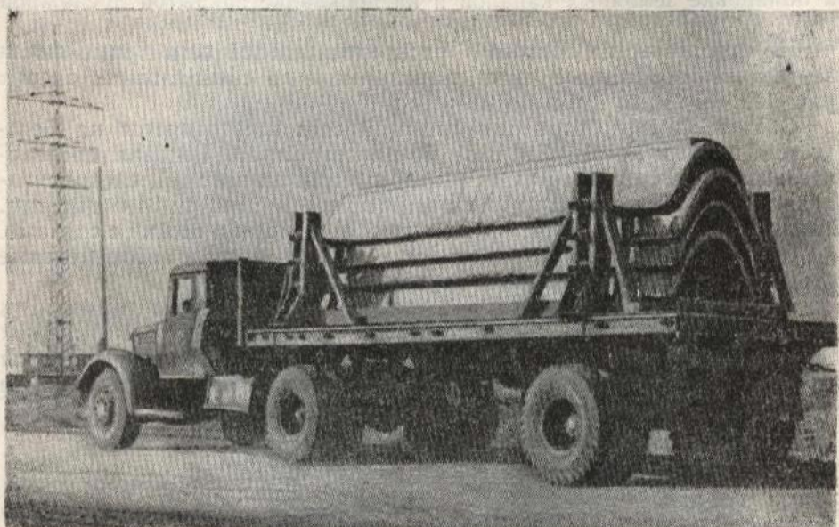
Рис. 2. Транспортировка лотков высотой 0,8 м на автолотковозе МАЗ-200В.
