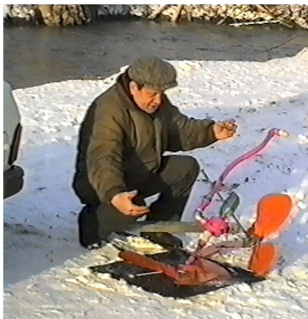
Фото 1 - Переносной свободно-поточный турбонасосный агрегат
