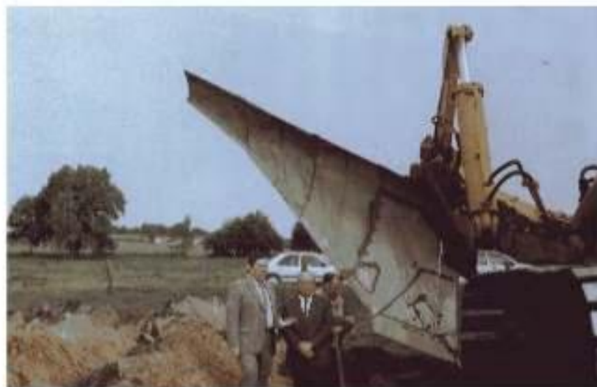
Плуг В. Оттомайер для создания негланой сменено-стойной кустурун земледелия на огушаных низинных торфяных болотлах, подстиловых мисках
