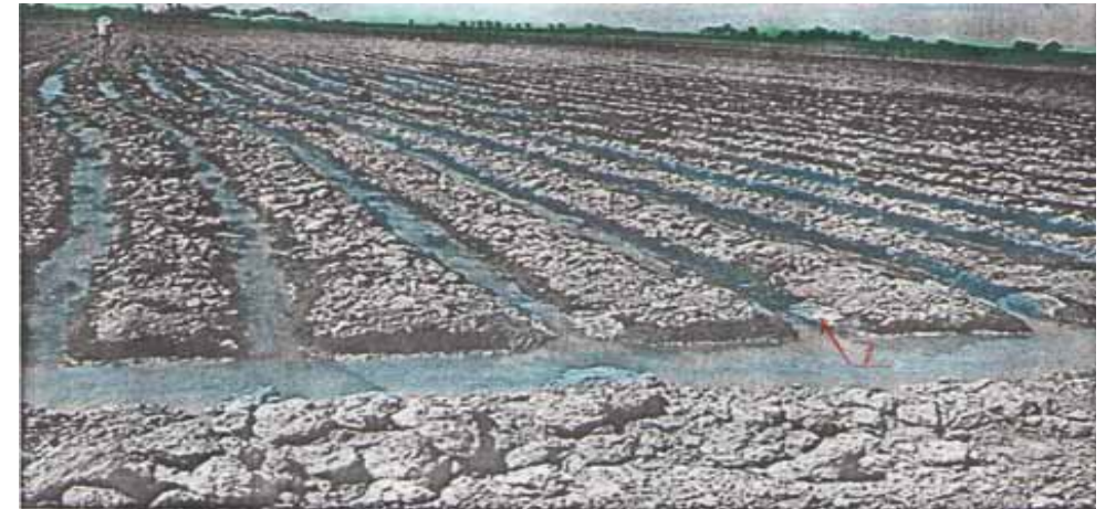
Фото 1. Пробный полив по бороздам 1 - армирование оголовка поливной борозды салфеткой из полиэтиленовой пленки
