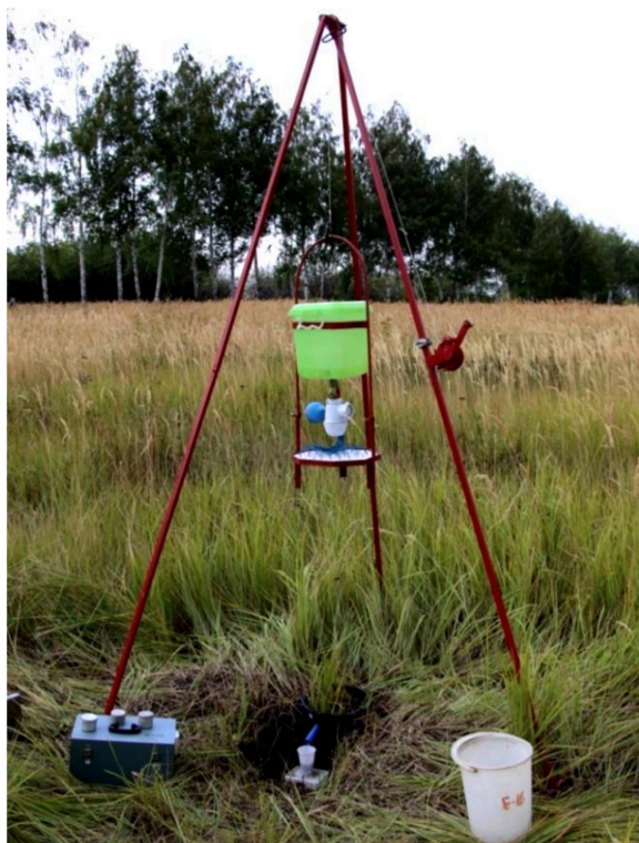
Рис. 2. Портативная ДУ с площадью стоковой площадки 0.05 м 2 .
