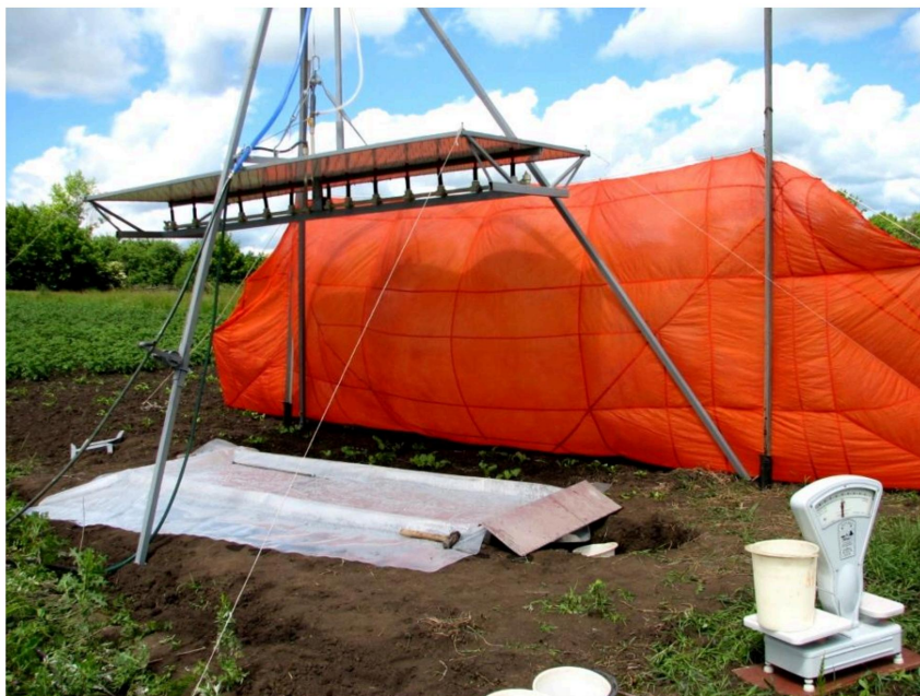
Рис. 1. Большая ДУ с площадью стоковой площадки 3 м 2 .
