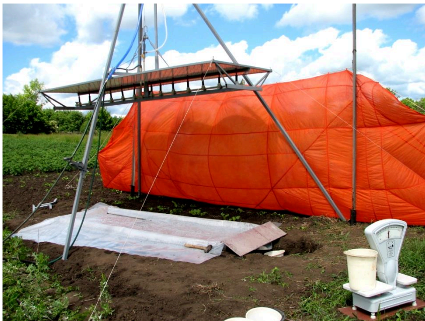
Рис. 1. Большая ДУ с площадью стоковой площадки 3 м 2 .
