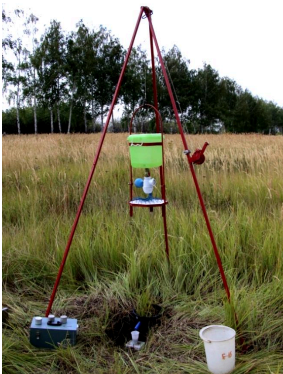
Рис. 2. Портативная ДУ с площадью стоковой площадки 0.05 м 2 .
