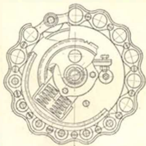
Рис. 22 Шпиндельный барабан хлопкоуборочной машины ХВС-1,2: 1 — приводная шестерня; 2 — вал барабана; 3 — шпиндель; 4 — приводные ролики шпинделя.
