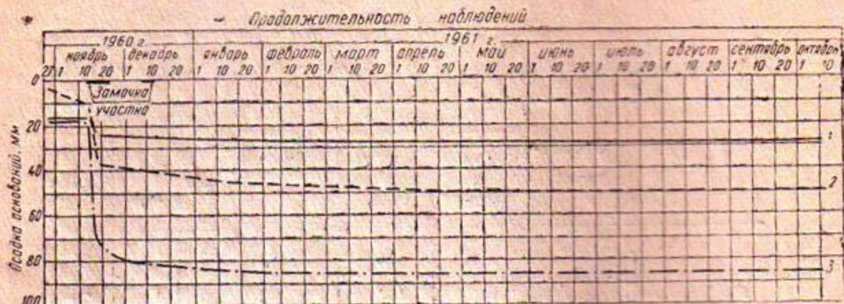
Рис. 2. График осадки опор лотков во времени. Котлованы, выштампованные в грунте оптимальной влажности, \omega=18\% (1), естественной влажности, \omega=8\% (2) и отрытые в грунте естественной влажности, \omega=8\% (3).
