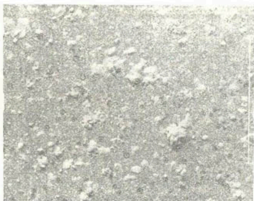
Рис. 26. Фотография частиц и комочков суглинка, вымытых из щели при градиенте напора, равном 6,2. Увеличено в 3,5 раза.
