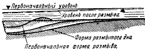
Рис. 4. Различные стадии размыва дна нижнего бьефа (продольный профиль).
