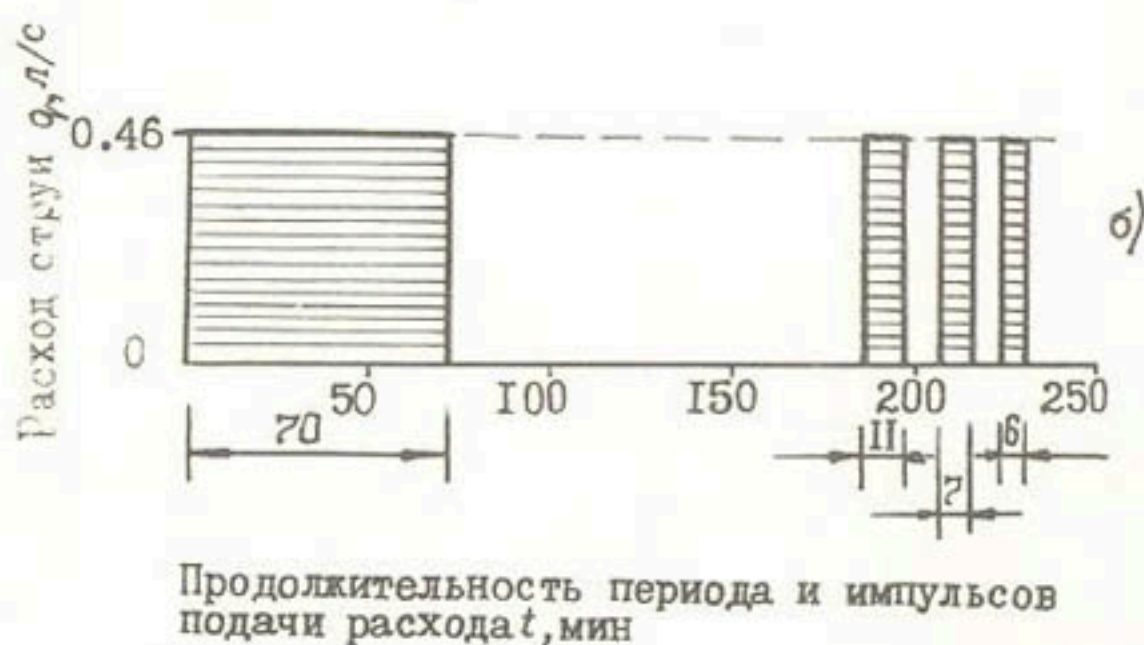
Рис Пробег потока воды в борозде при широтно-частотной подаче поливной струи с продолжительностью импульса, равной времени добегания: а – пробеги потока в борозде; 1, 2, 3, 4 – пуски воды в борозду; б – продолжительность и период импульсов подачи воды
