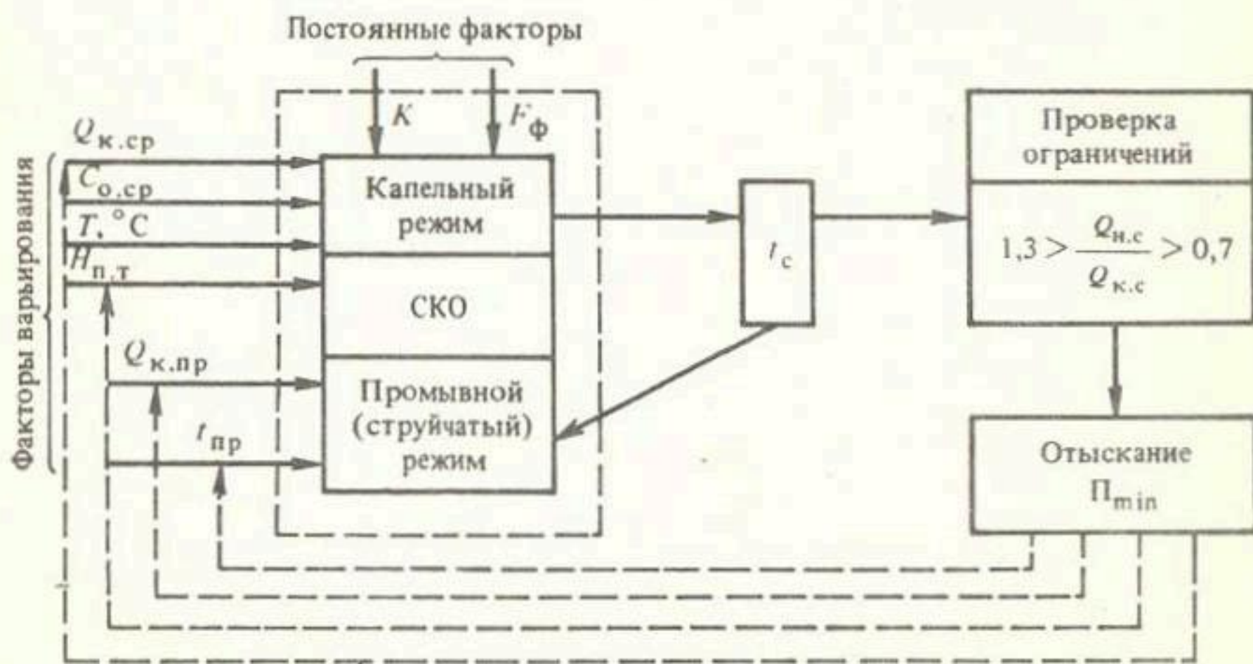
Рис. 2. Структурная схема оптимизации работы поливной сети СКО
