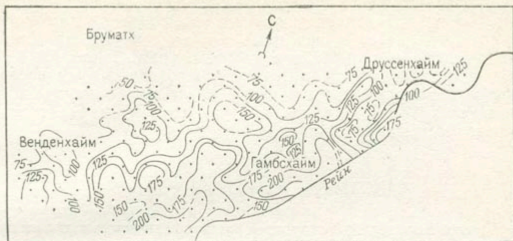
Рис. 4.3.3. План распределения исправленных значений поперечного электрического сопротивления водоносного горизонта (в 100 \text{ Ом} \cdot \text{м}^2 ) [71]
