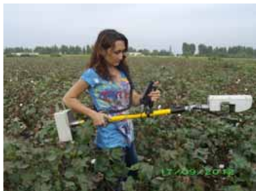
Рис. 1 - Измерения NDVI прибором GreenSeeker
