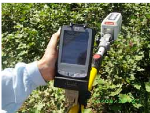
Рис. 1 - Измерения NDVI прибором GreenSeeker
